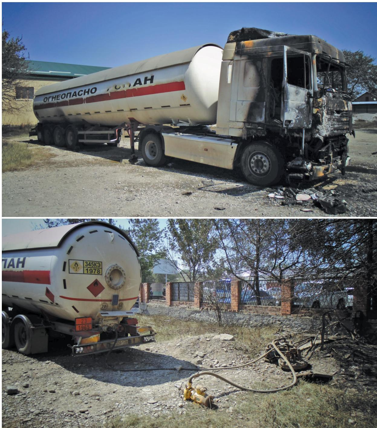
**Рис. 39.** Результаты взрыва газовоздушной смеси и пожара на территории АГЗС вследствие утечки газа в г. Сунже
