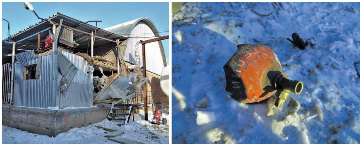
Рис. 36. Результаты взрыва баллона при наполнении его гелием в помещении ангарного типа ООО «АРНИКА-ПРОМ-СЕРВИС»
